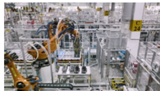
一汽大众黑灯车间电池包自动化装配产线
